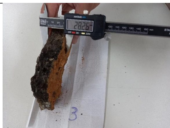
Medida de espessura do pavimento asfáltico na amostra 3 do fragmento do trecho rompido entre as estacas 10 e 11 da via de acesso ao Povoado Tapera. Aracaju/SE, em 15.06.2022
